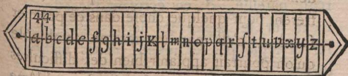
Celui qui voudra écrire à l'autre se servira d'un ruban, d'une ficelle ou d'un fil qu'il fixera aux deux extrémités de la règle, aux deux endroits marqués par des points vers le point *a* & le point *Z*; alors il marquera sur le ruban ou sur le fil, soit par un nœud, soit avec de l'encre, la première lettre qu'il voudra indiquer; ensuite il portera à l'extrémité de la règle vers le point *a* le nœud ou la marque qui exprime
