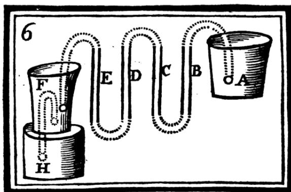
Au point *A*, est un bassin caché dans le corps du bâtiment, les quatre colonnes ne sont qu'un seul & même tuyau de verre, recourbé comme le représente la figure; c'est à proprement parler, un syphon par où l'eau s'écoule du bassin *A* au bassin *F*, qui est pareillement caché dans le corps du bâtiment.
