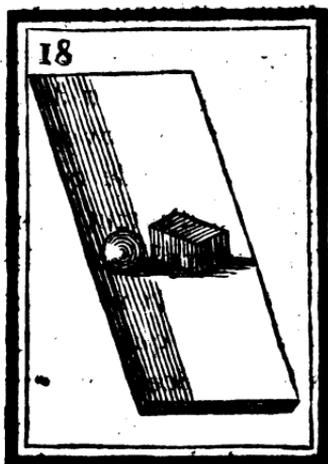
On demande quelle figure il faut donner à un corps solide, pour qu'étant posé sur un plan incliné, il avance en quelque façon de bas en haut, par sa seule pesanteur, de manière qu'à chaque nouvel instant, il s'appuie sur des points plus élevés qu'à l'instant précédent. Le corps ne doit contenir aucun appareil Chimique ou Mécanique ; il ne doit y avoir ni eau, ni vif-argent, ni fluide quelconque, & son mouvement ne doit être que l'effet de sa forme extérieure, combinée avec sa pesanteur.
