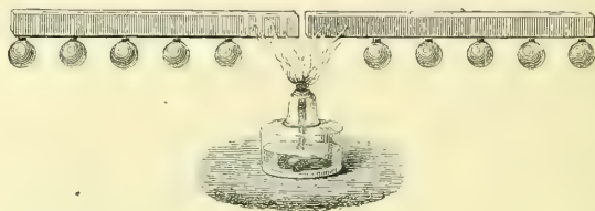
Fig. 317. — Inégales conductibilités du cuivre et du fer.
