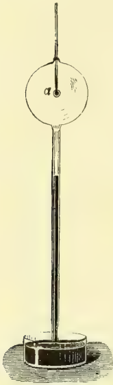
Fig. 303. — Rayonnement de la chaleur obscure dans le vide.
