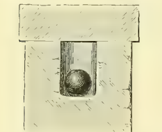
Fig. 322. — Mesure de la chaleur spécifique des corps. Méthode du puits de glace.
