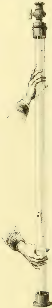
Fig. 4. Expérience démontrant l'égalité de vitesse des corps qui tombent dans le vide.
