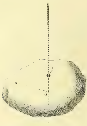
Fig. 23. — Détermination expérimentale du centre de gravité d'un corps de forme irrégulière, ou non homogène.
