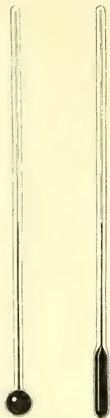
Fig. 281. — Réservoir et tube du thermomètre à mercure.
