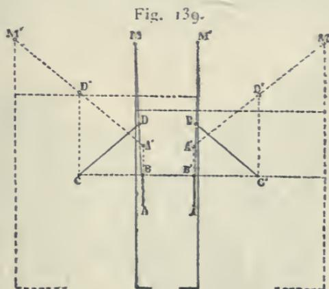
tèmes à deux manivelles soudées à un axe, et directement opposées ; on obtient un mécanisme où la rotation de l'axe se transforme en mouvement de deux points qui, tour à tour, parcourent une même ligne droite, et dont chacun s'élève successivement au-dessus de cette ligne après l'avoir parcourue quand l'autre s'abaisse sur elle pour la parcourir. Plaçons à côté, pour l'équilibre, un appareil
