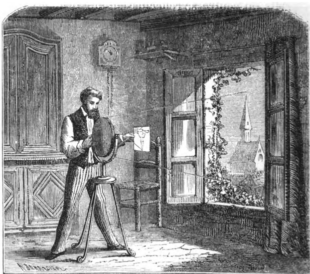
Fig. 23. — Renversement des images par le miroir concave.
