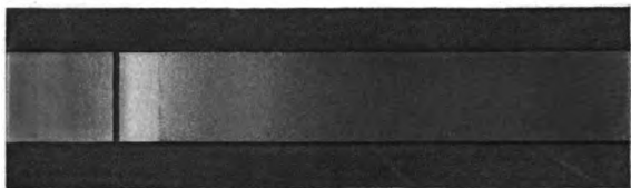
Spectre montrant l'absorption par la vapeur de Sodium (Fig. 6.)
