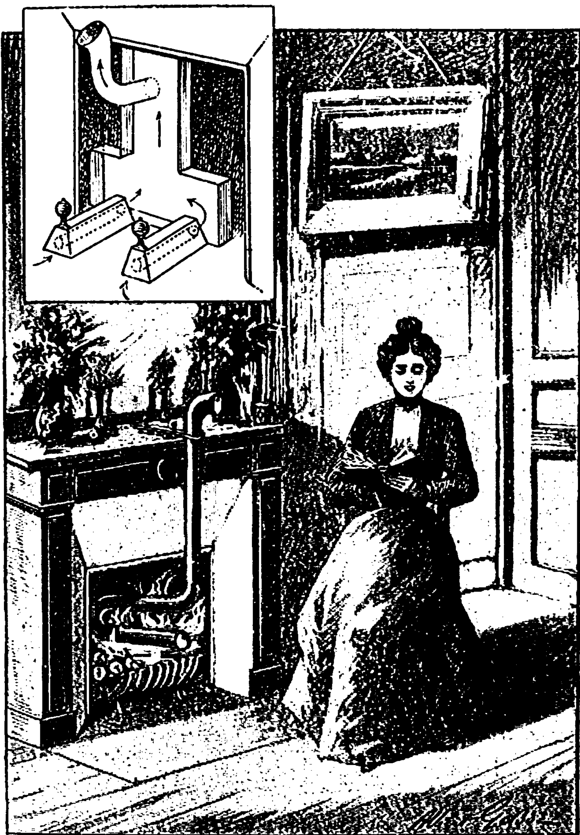
Fig. 110. — 1. Chenêts creux : « le Tropic ». — 2. Le thermophore.
