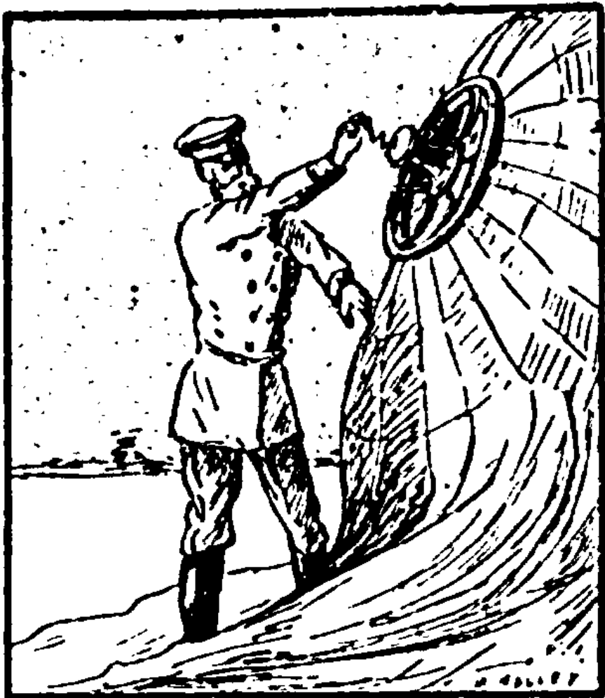
Fig. 163. — Combustion d'un ballon provoquée par une étincelle tirée de la soupape.
