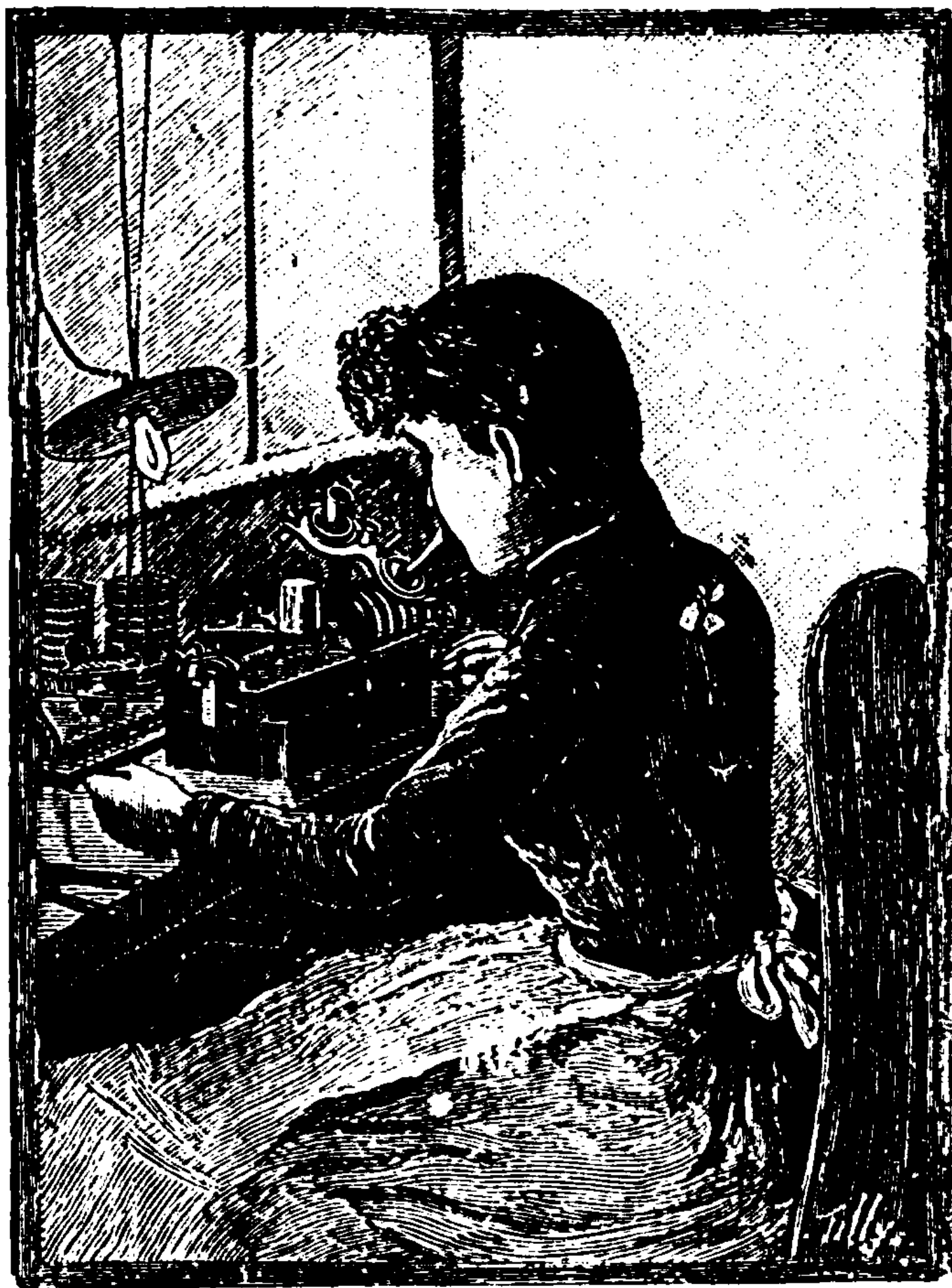
Fig. 68. — La parleuse; ouvrière impressionnant les cylindres.
