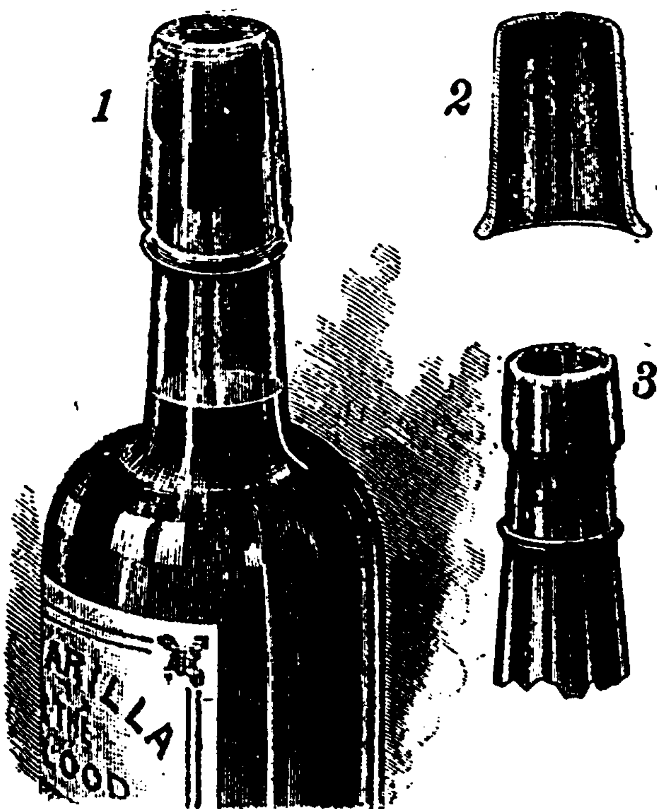
Fig. 175. — La bouteille de sûreté. — 1. La bouteille munie du manchon. — 2. Le manchon. — 3. Goulot avec renflement.
